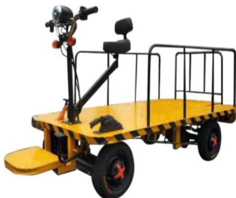
**Figura 6** – Carrinho elétrico para coleta de material de poda
