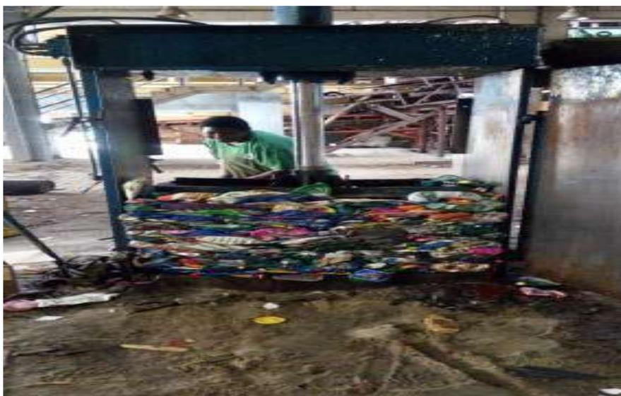
Foto 5 - Prensa hidráulica PP/PEAD
