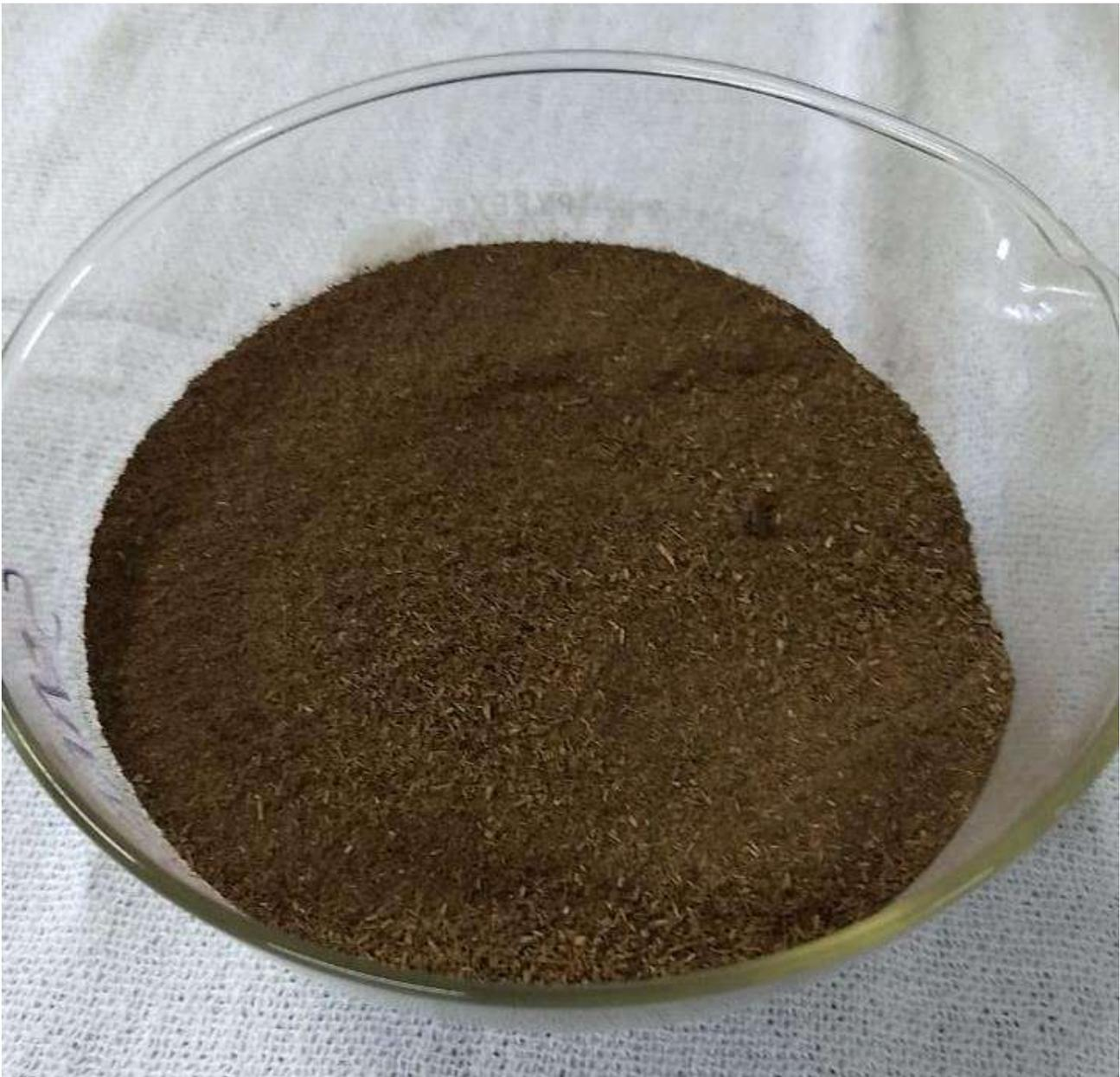
**Figura 26 – Aspecto final do produto gerado após 55 dias de compostagem em leira de aeração passiva processado em peneira de 9mm**
