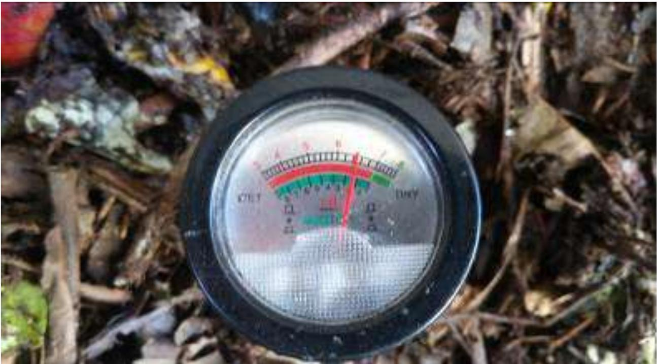
**Figura 17 – Aferição do teor de umidade da massa inicial de entrada no reator de metanização.**
