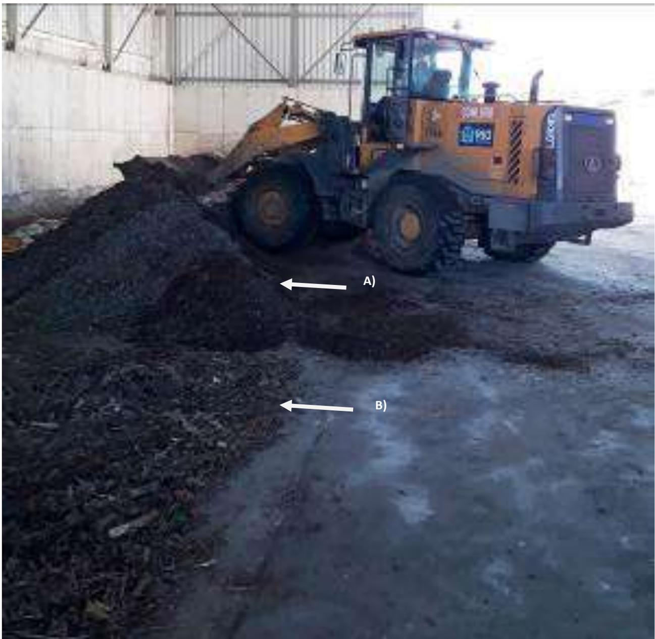
**Figura 19 – Aspecto final das etapas de montagem: A - Mistura de resíduos de alimentos e de resíduos de poda fino; B - Base da leira com os resíduos de poda de granulometria grossa**
