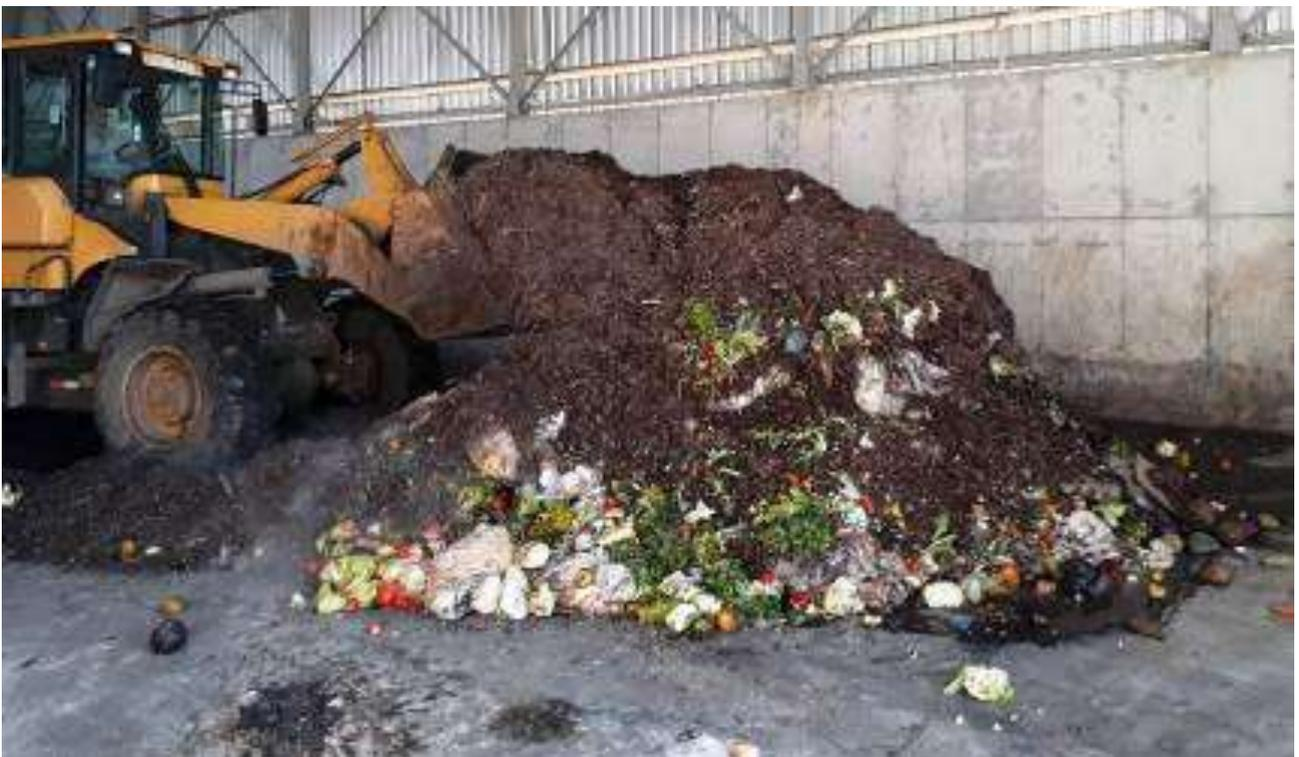
**Figura 14 – Incorporação dos resíduos de poda fino ao lixo orgânico até a obtenção de 50-60% umidade**
