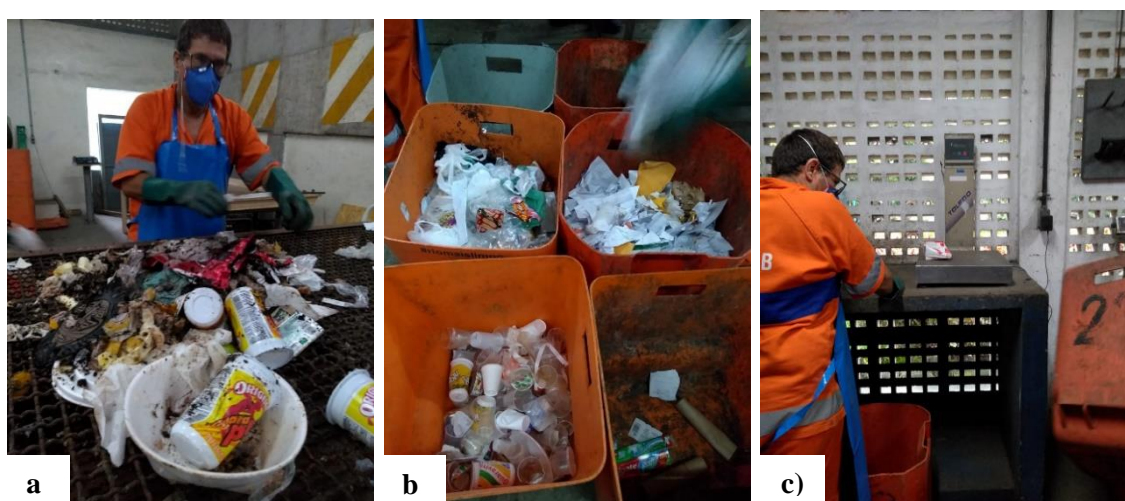
Figura 3. Análise dos RS gerados no PAB – (a) Triagem manual dos componentes em mesa de separação, (b) Componentes separados em contêineres, (c) Determinação da massa de cada componente identificado.
